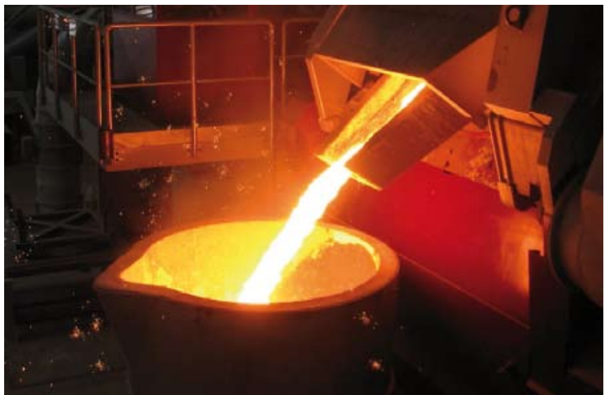
Abguss aus einem 12-t-Induktionstiegelofen
