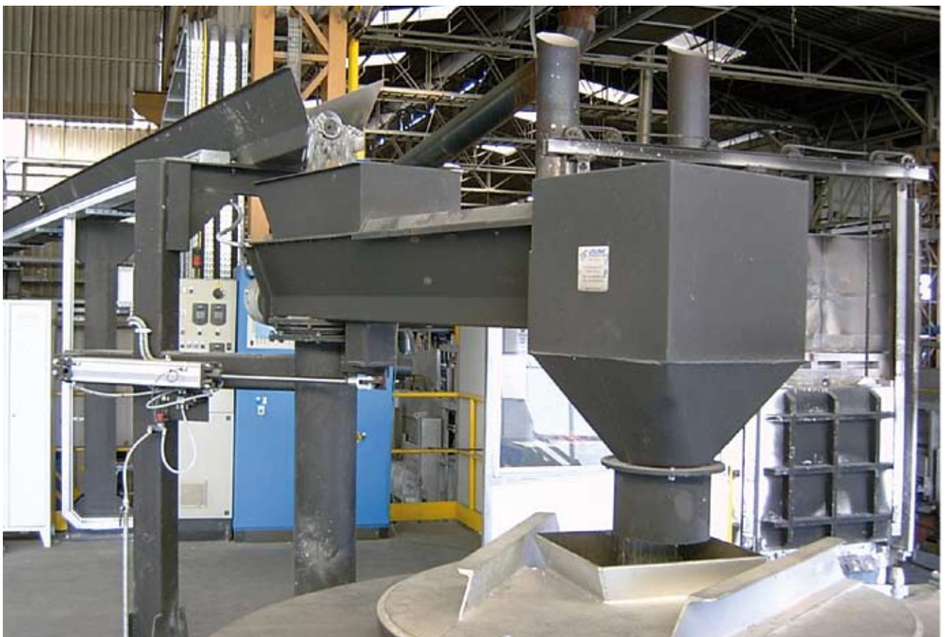
Beispiel einer Induktionstiegelofenanlage zum Einschmelzen von feinkörnigen Materialien
