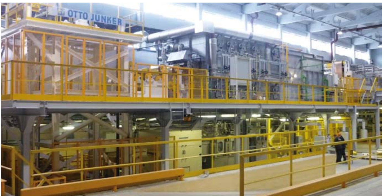
Bandbehandlungsanlage im Kirov-Werk
