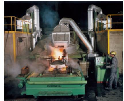
50-t-MFT-Ofen an einer vertikalen Stranggießanlage
