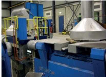
Induktionsofenanlage für Magnesium
