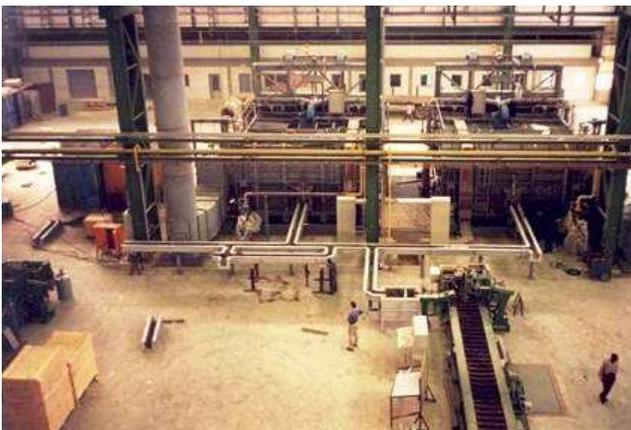
OTTO JUNKER verfügt über umfassende Erfahrungen in der Konstruktion und Montage von Rinnensystemen. Unterstützt wird dieses Know-how durch eine eigenentwickelte Software zur Auslegung offener und geschlossener Rinnen, den Einsatz modernster Auskleidungsmaterialien sowie Beheizungs- und Vorwärmssysteme, die von gasbeheizten Lösungen für Überführungsrinnen bis hin zu elektrischen Beheizungseinrichtungen für Gießbrinnen reichen.
