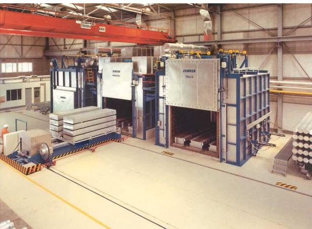
Die erste Abkühlung der Bolzen gemäß den jeweiligen metallurgischen Anforderungen kann innerhalb des Homogenisierungs-ofens erfolgen, um ein homogenisiertes Endprodukt mit optimalen Eigenschaften zu erhalten.
