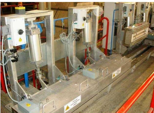
Rinnen werden grundsätzlich für die erforderliche Überführungs- bzw. Gießleistung dimensioniert. Das Zubehör- und Ausstattungsprogramm umfasst lasergestützte Füllstandsregelung für die (halb-) automatische Metallüberführung und für den automatischen Abguss, Metallsonden zum Schutz vor Überlauf, Thermoelemente zur Feinabstimmung der Gießtemperatur usw.
