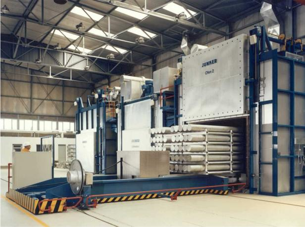
Homogenisierungsöfen von OTTO JUNKER sind für Strangpressbolzen unterschiedlichster Abmessungen geeignet und zeichnen sich durch engste Temperaturtoleranzen aus. Diese satzweise arbeitenden Homogenisierungsöfen bieten die erforderliche Flexibilität bei der Behandlung von Bolzen verschiedenster Durchmesser und Legierungen.
